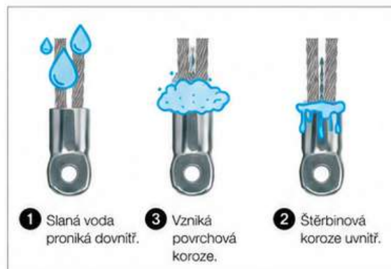
Obrázek 2: Fáze vzniku štěrbinové koroze při reakci se solí a chemikáliemi.
